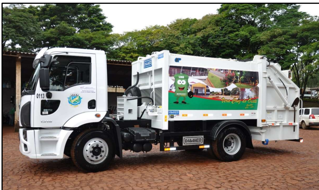
Figura 18 - Caminhão compactador utilizado na coleta convencional de resíduos domiciliares do município de Vera Cruz do Oeste/PR
